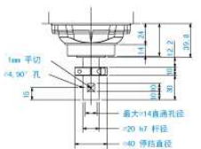
A部详图 (第3、4关节处于原点的姿态)
