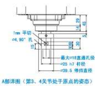
A部详图 (第3、4关节处于原点的姿态)
