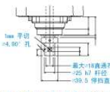
部详图 (第3、4关节处于原点的姿态)
